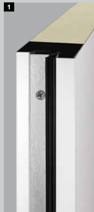
1 La porte de sécurité KSI Thermo convainc par son panneau de porte de 46 mm d'épaisseur et son très bon coefficient d'isolation pouvant atteindre 1,1 \text{ W}/(\text{m}^2 \cdot \text{K}) .
